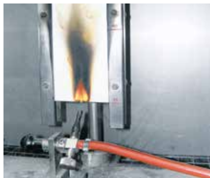
Qualitätsprüfungen über den gesamten Fertigungsfluss: Brandprüfung
