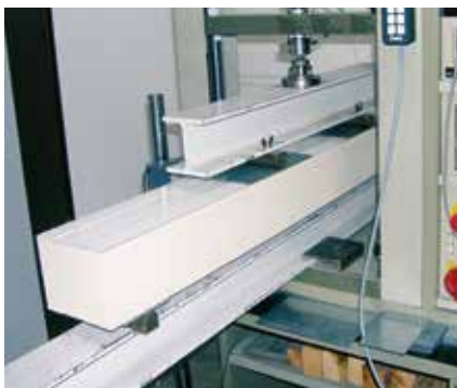
Computergestützte Qualitätsprüfungen: Biegeprüfung
